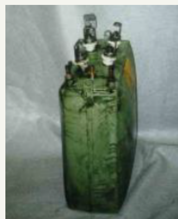
Figura 5: Capacitor de forma convexa o hinchada
