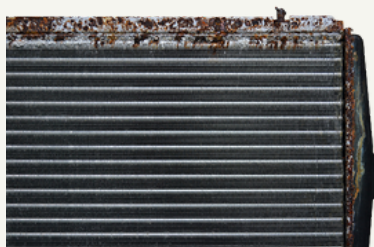
Figura 3: Corrosión en las aletas del radiador
