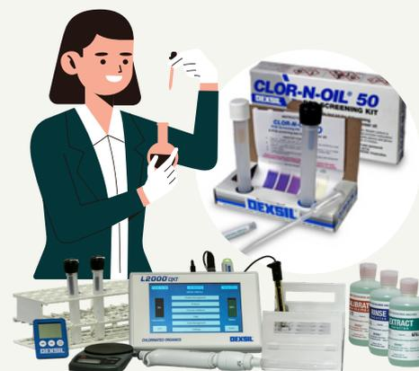
Si un equipo de prueba muestra un resultado positivo de detección ( $\text{PCB} \geq 50 \text{ ppm}$ ) siempre es necesaria una verificación por cromatografía gaseosa.
